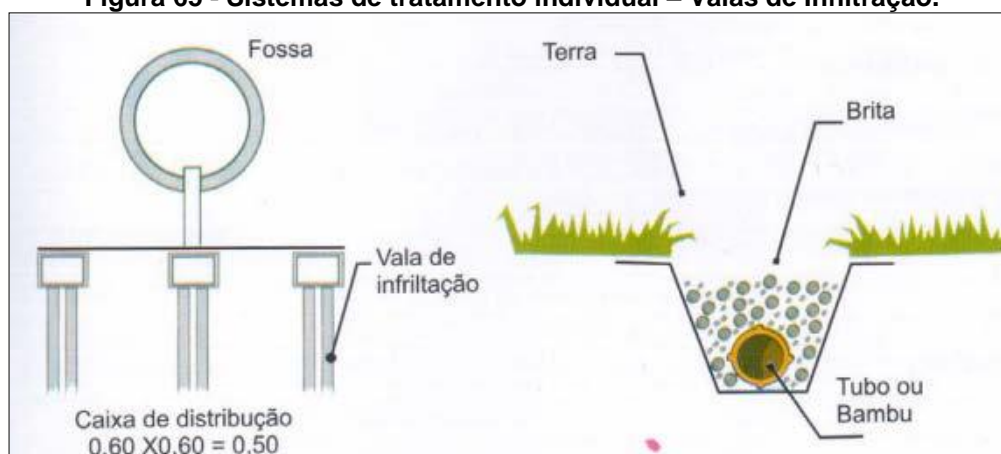
Figura 65 - Sistemas de tratamento individual – Valas de Infiltração.
