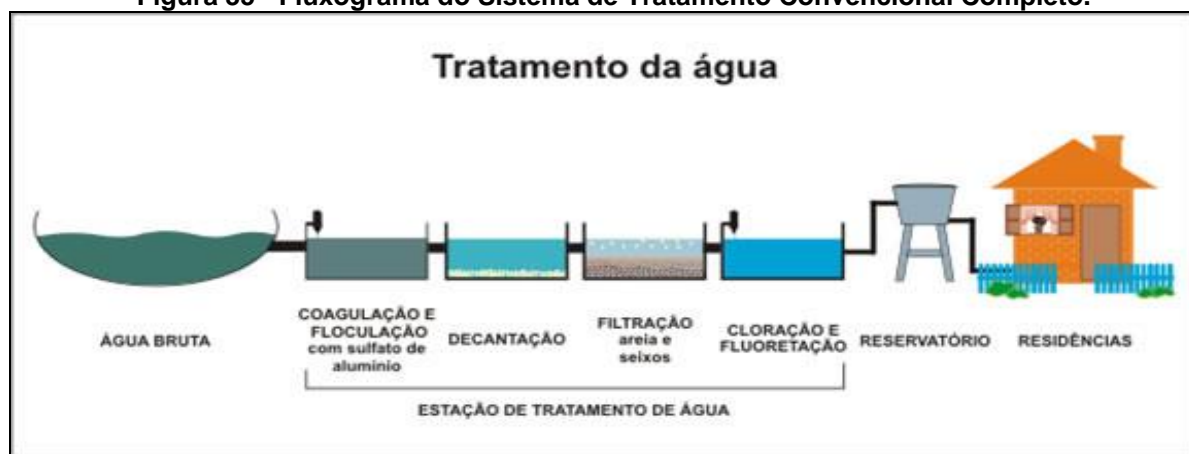
Figura 35 - Fluxograma do Sistema de Tratamento Convencional Completo.
